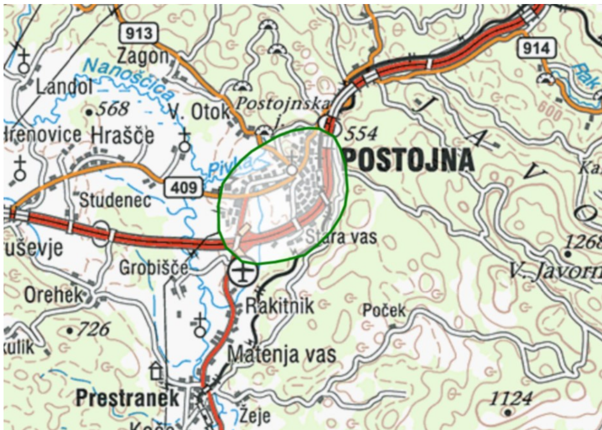
Slika 9: Območje pokrivanja radijske frekvence Postojna 4 94,7 MHz (sklop Postojna)
