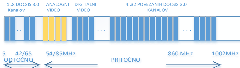
Slika 12: Razdelitev frekvenčnega spektra v kablenskem omrežju DOCSIS 3.0
